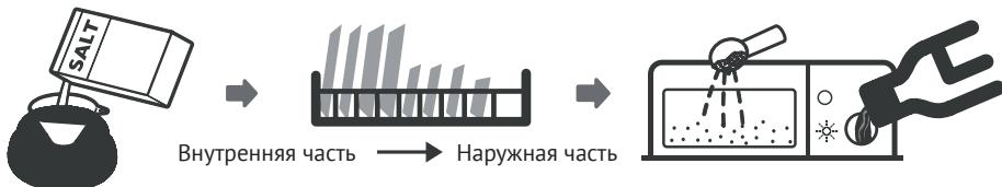
1. Отрегулируйте устройство умягчения воды.
